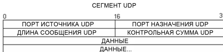
Используя захваченные программой Wireshark данные первой датаграммы UDP, заполните информацию о заголовке UDP. Значение контрольной суммы имеет шестнадцатеричный формат (по основанию 16) с предваряющим кодом 0x.
